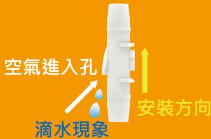
破虹吸管需安裝在儲水缸內，且須高於水面。
